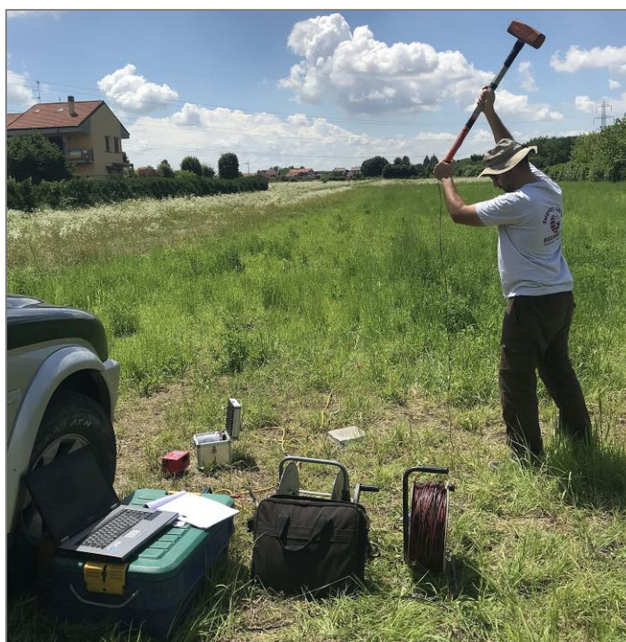
Fig. 40. Stendimento sismico per la prova ReMi/MASW sul sito d'indagine R3.
